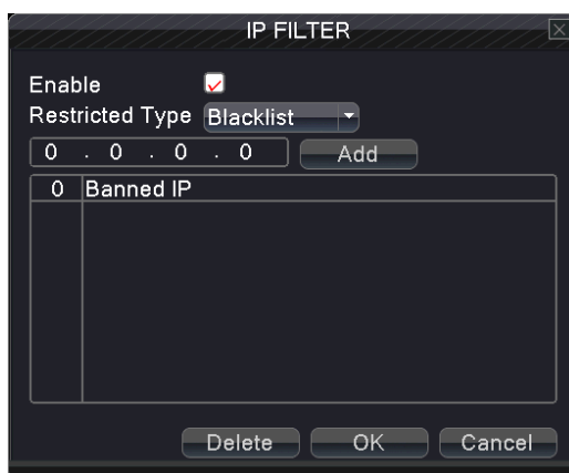
Рисунок 4.11 Настройка IP фильтра
